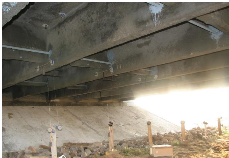
Рис. 5. Расстановка прогибомеров и деформометров в сечении 0,4L
