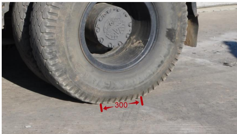
Рис. 3. Фото пятна касания автомобиля МАЗ. Сделано при испытании путепровода. Масса автомобиля 32 тонны
