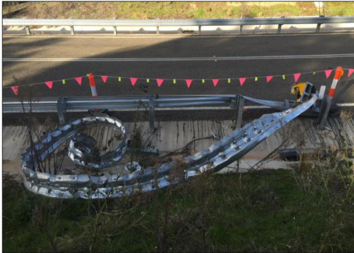
Рис. 3. Поврежденная W-образная балка после прохождения через ударную головку
