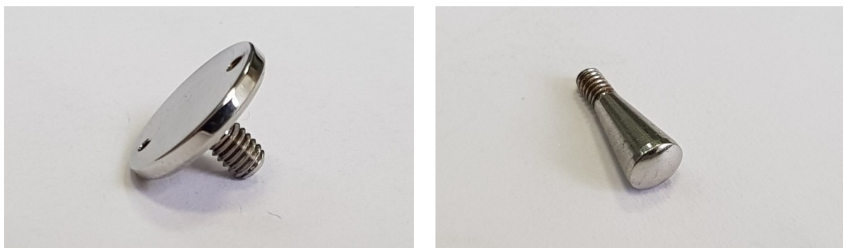
Рисунок 3 – Образцы изделий из коррозионностойкой стали после полирования с применением управляемых импульсных режимов электролитно-плазменной обработки
