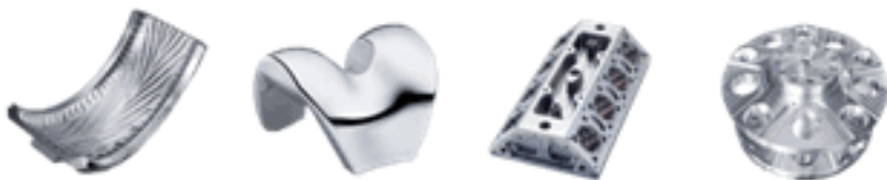
Рисунок 1 – Типовые детали 5-осевой обработки
