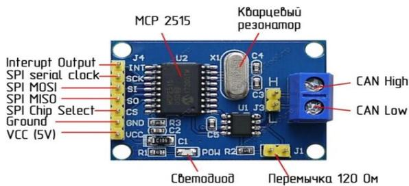
Рисунок 4 – Микросхема MCP 2515
