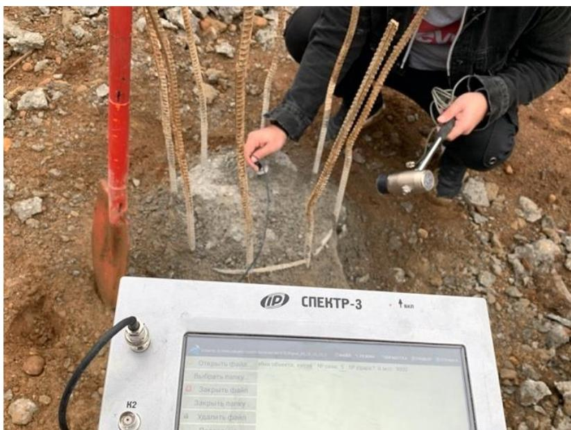
Рис. 2. Установка сенсора-акселерометра на сваю
