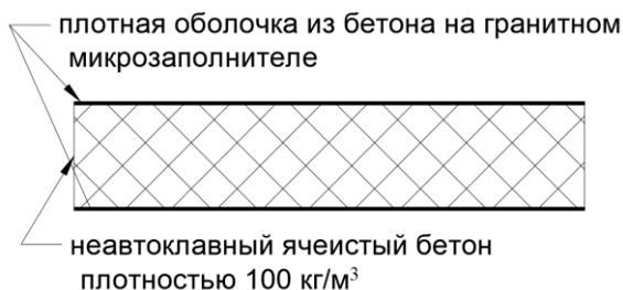
Рис. 3. Теплоизоляционная плита из сверхлегкого ячеистого бетона
