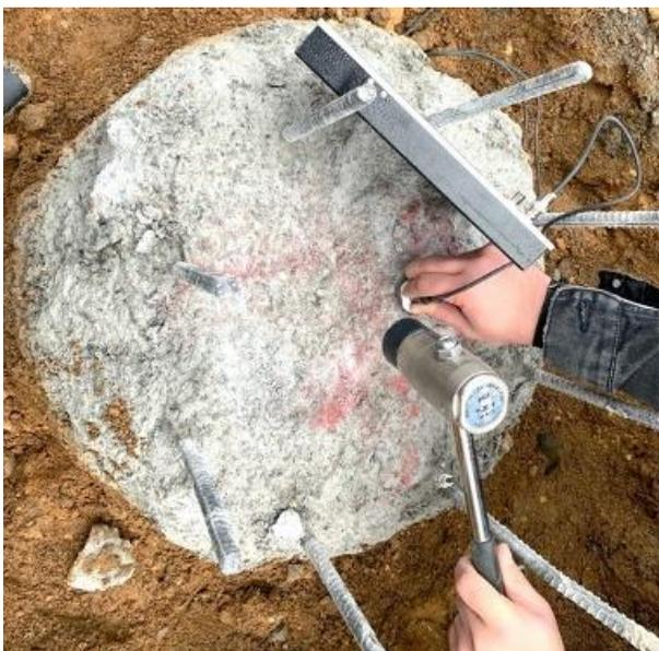
Рис. 3. Нанесение удара по оголовку сваи
