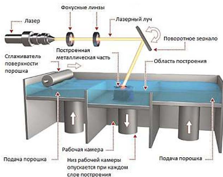
Рис. 1. Принципиальная схема построения изделий методом селективного лазерного плавления
