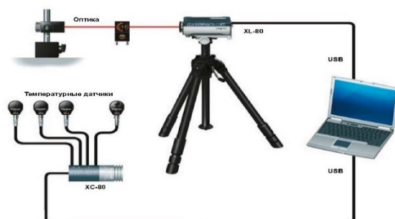
Рис. 3. Принципиальная схема работы лазерного интерферометра
