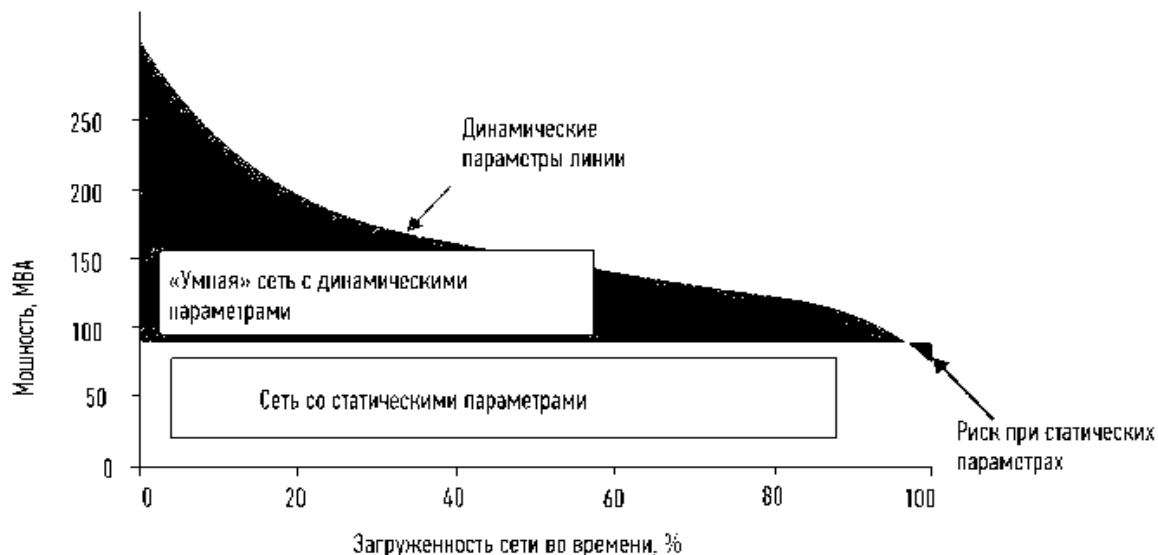
Рисунок 1– Эффективность передачи энергии в ЛЭП со статическими и динамическими параметрами
