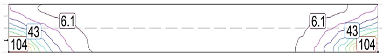
Рисунок 6 – Распределение освещенности по поверхности дороги с использованием светильника GALAD 160 Вт с расстоянием между опорами 80 м
