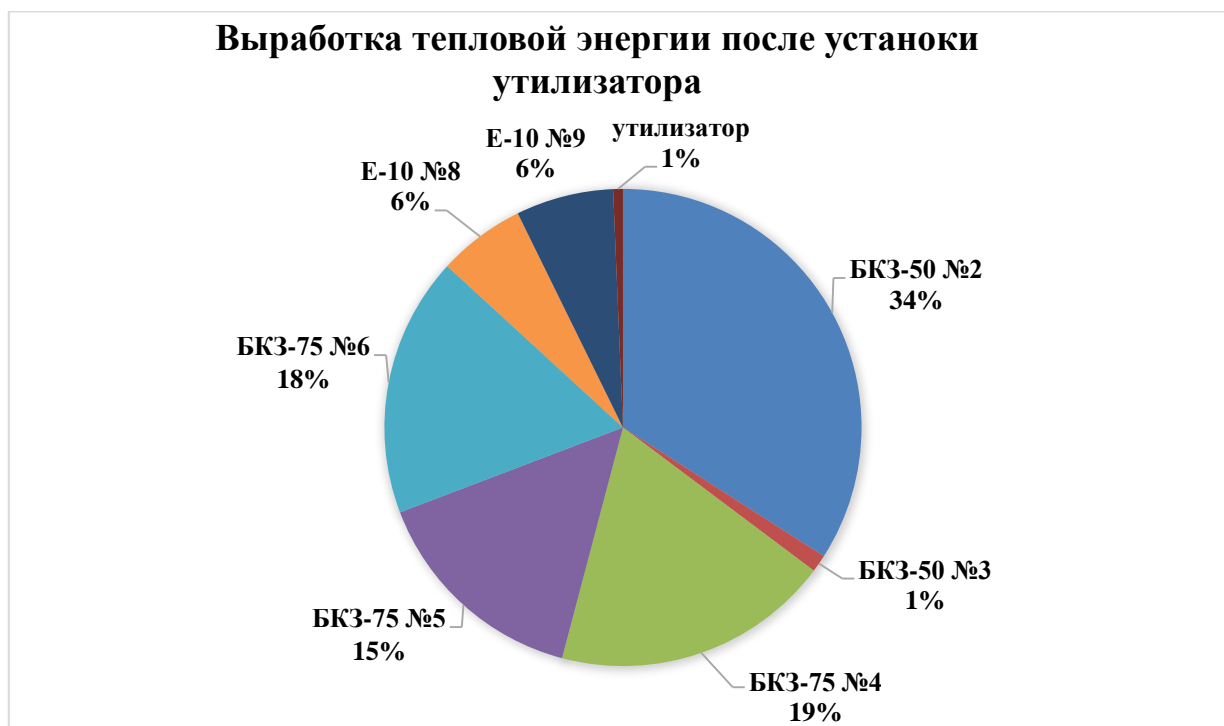
Рисунок 3 – Выработка тепловой энергии Пинской ТЭЦ после установки утилизатора за год
