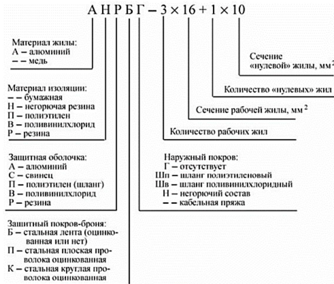
Рисунок 2 – Маркировка силовых кабелей
