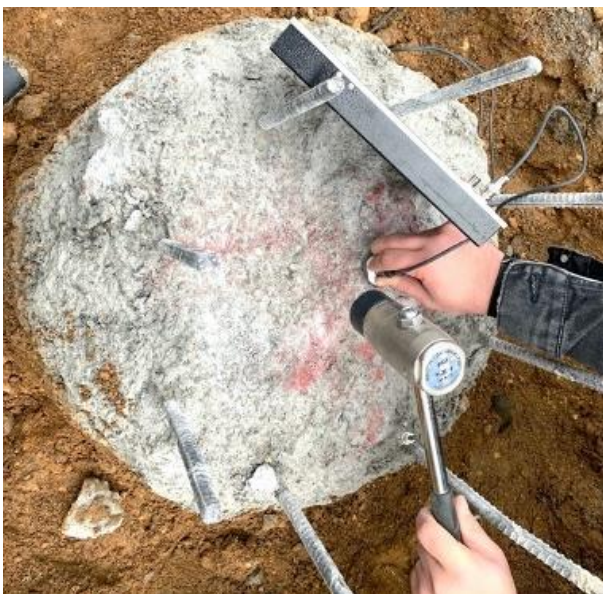
Рис. 3. Нанесение удара по оголовку сваи
