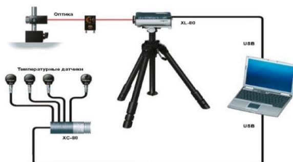
Рис. 3. Принципиальная схема работы лазерного интерферометра
