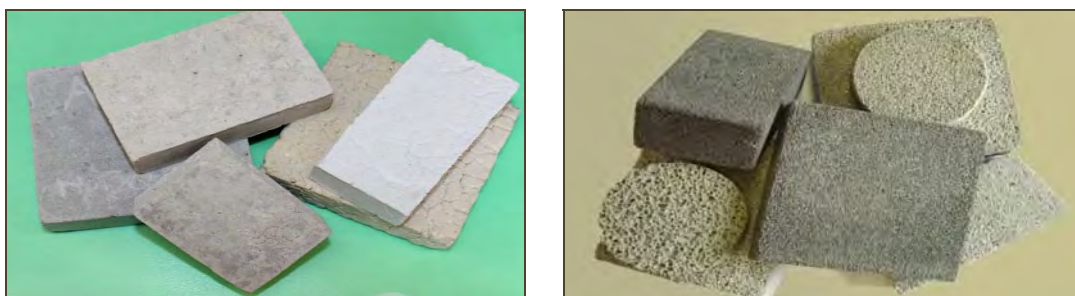
Рисунок 6 – Фотографии пеносиликатных (слева) и пеностеклокерамических (справа) материалов на основе кремнеземов техногенного и природного происхождения
