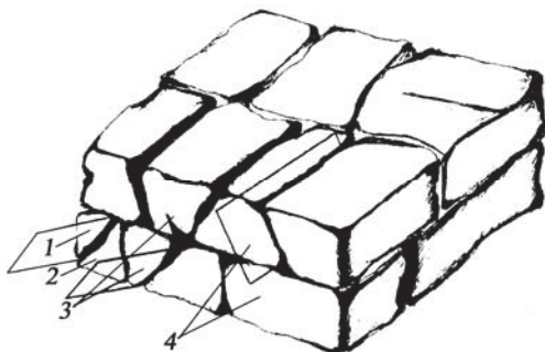
Рисунок 1.2 – Схема разделения массива каменной кладки вертикальными плоскостями (кладочными швами)
