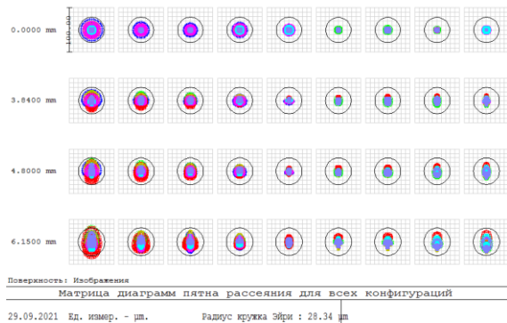
Рисунок 5 – Функция рассеяния точки вариообъектива по девяти конфигурациям
