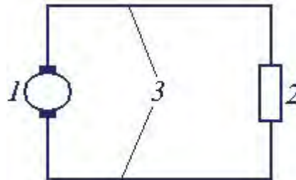
Рис. 2.4. Основные элементы электрической цепи: 1 – источник электрической энергии, 2 – потребитель, 3 – соединительные провода
