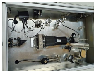
Рисунок 1 – Оптическая схема спектрометра ЛАЭМС
