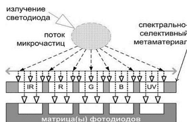
Рисунок 1 – Схематическое изображение принципа работы мультиспектрального детектора микрочастиц с использованием оптических фильтров на основе метаматериалов на плазмонных эффектах в сборке с матрицей фотодиодов
