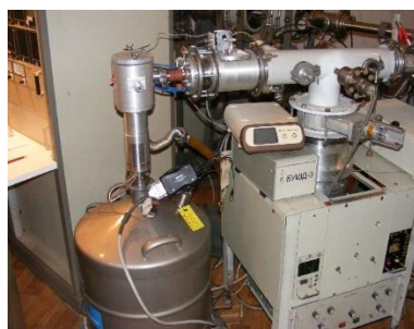
Рисунок 1 – Общий вид программно-аппаратного комплекса для высоколокального исследования состава материалов автофокусированным протонным пучком
