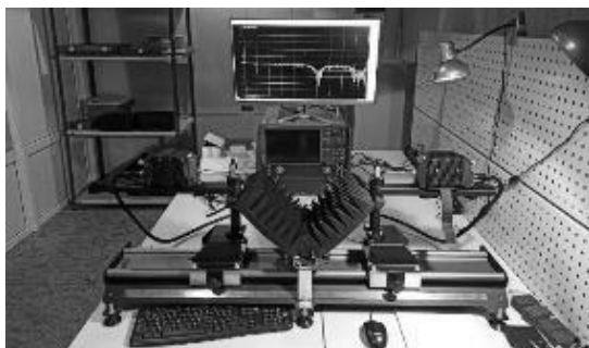
Рисунок 2 – Аппаратно-программный комплекс для измерения параметров материалов на базе векторного анализатора цепей N5290A фирмы Keysight Technologies (США)
