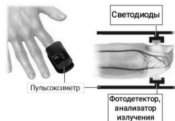
Рисунок 4 – Устройство пульсоксиметра
