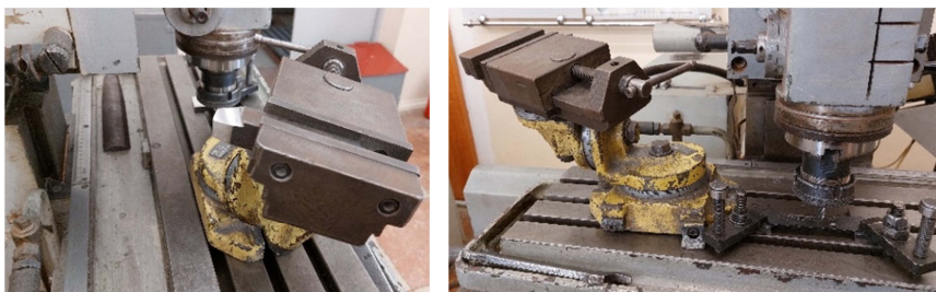
Рис. 1.9. Тиски трехугольные поворотные
