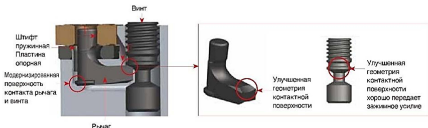
Рис. 1.5. Система крепления с двойным усилием L-образным рычагом по типу P
