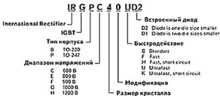
Рис. 3.2. Схема расшифровки обозначений IGBT IR инверторов
