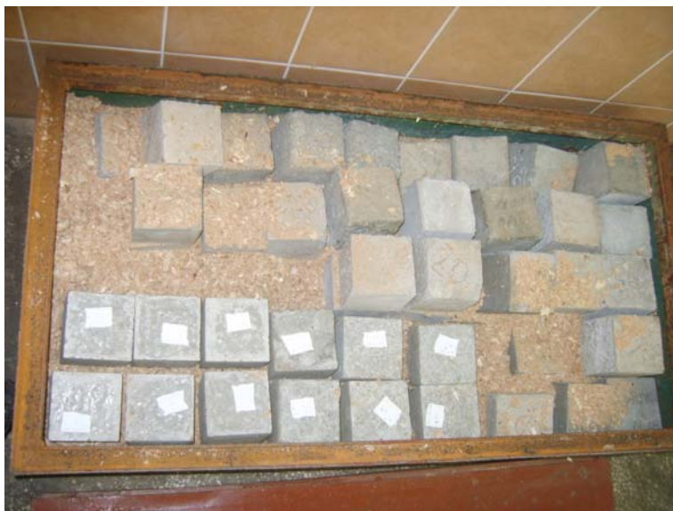
Рис. 4.1. Образцы в камере в нормально-влажностных условиях
