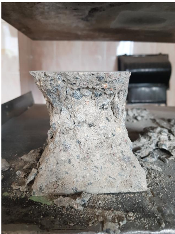
Рис. 4.4. Образец без полипропиленовых фибр после испытания
