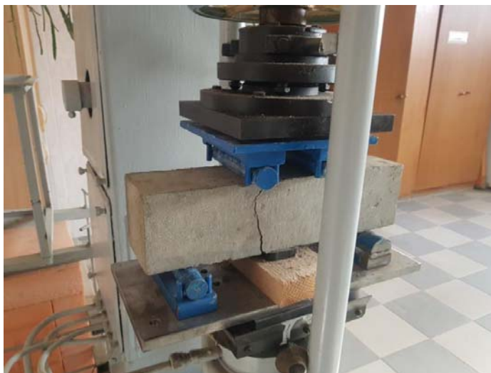
Рис. 4.7. Испытание бетонной призмы
