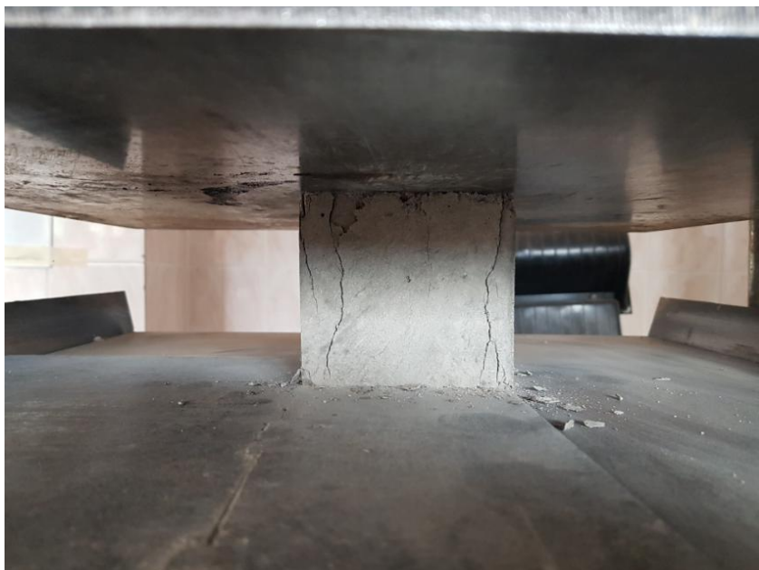
Рис. 4.5. Образцы, армированные полипропиленовой фиброй, после испытания на сжатие
