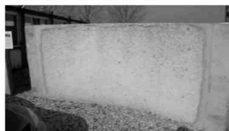
Железобетон с 2 кг/м 3 ПП фибры Глубина отколов – 15 мм
