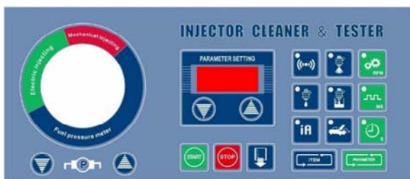
Рис. 3.2. Панель управления стенда «INJECTOR CLEANER & TESTER TEKTINO INJ-4B»
