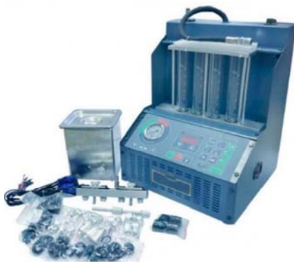
Рис. 3.1. Общий вид стенда «INJECTOR CLEANER & TESTER TEKTINO INJ-4B»
