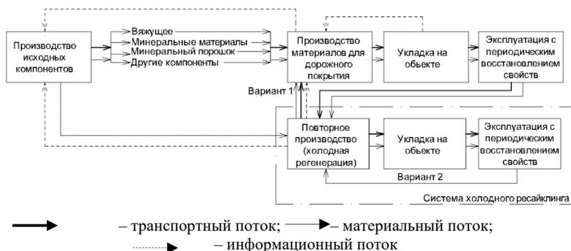
Рисунок 1 – Логистические потоки в системе строительства и восстановления дорожного покрытия методом холодной регенерации
