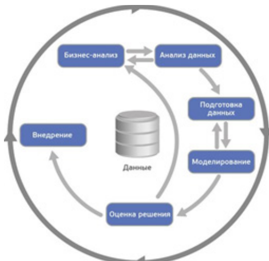
Рисунок 3 – Стандартная методология машинного обучения (Cross Industry Standard Process for Data Mining, CRISP-DM)
