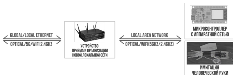
Рисунок 2 – Теоретическая организация шин данных работы исполнительной системы машинного зрения (клиентская сторона)
