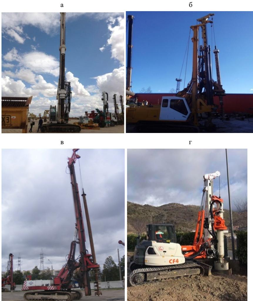
*Рис. 1.6.* Буровые установки ГГК для изготовления свай под защитой обсадных труб: а – MDT CMV TH16; б – BAUER BG 12/15K; в – DELMAG RH14; г – TESCAR CF4
