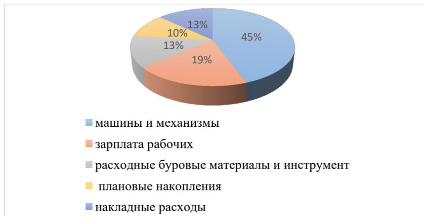
Рис. 1.25. Осредненная структура затрат на изготовление одного кубического метра анкера или сваи (без бетона и арматуры) ГГК
