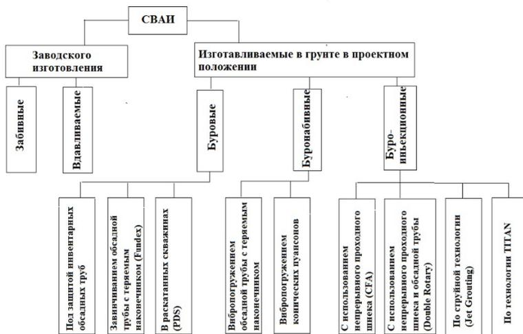
Рис. 1.1. Классификация свай и современных технологий их изготовления
