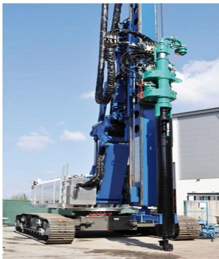
Рис. 1.10. Буровая установка ABI TM 20/25 с вращателем двойного действия VDW6035
