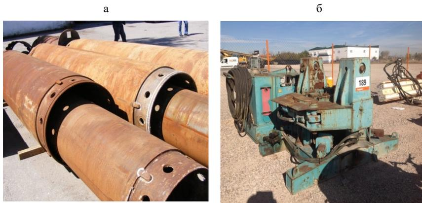
Рис. 1.5. а – обсадные инвентарные трубы; б – стационарный осциллятор фирмы CASAGRANDE для их извлечения
