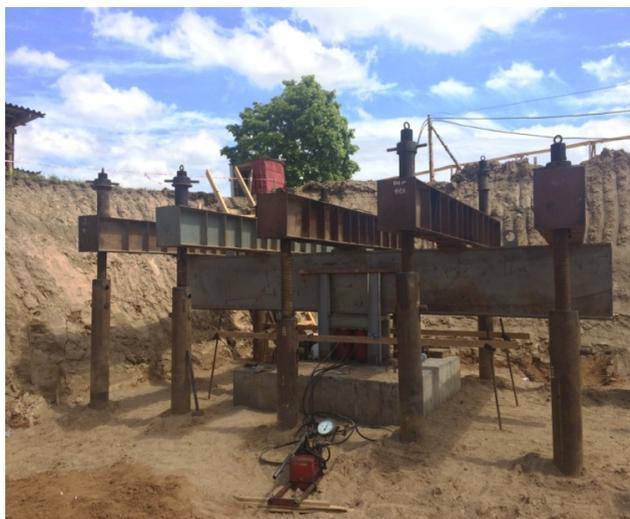
*Рис. 1.35.* Грузовая платформа с анкерным креплением для статического испытания штампа или свай
