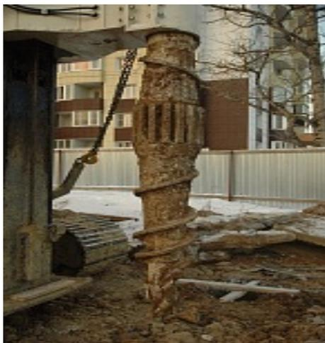
*Рис. 1.11. Общий вид шнека-раскатчика*
