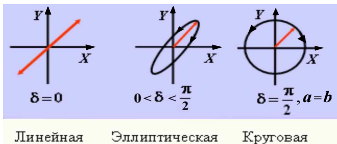
Рис. 3.6. Состояния поляризации плоской монохроматической волны
