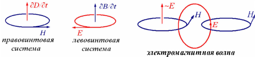
Рис. 3.1. Возникновение электромагнитной волны
