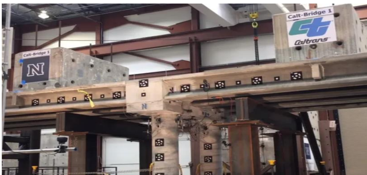
Рисунок 1 – Испытание в сейсмологической лаборатории Невады 100-тонной модели моста
