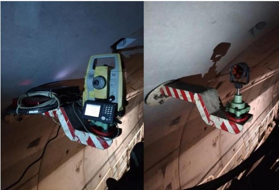
Рисунок 5 – Тахеометр и призма на консоли
