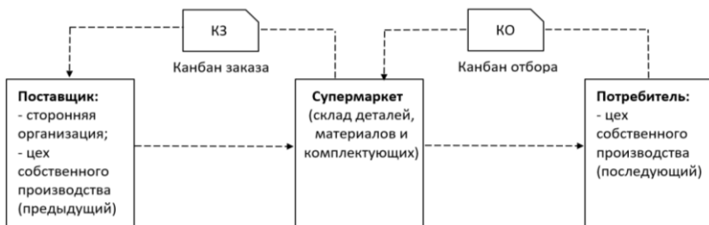
Рис. 1. Схема функционирования канбан отбора и канбан заказа
