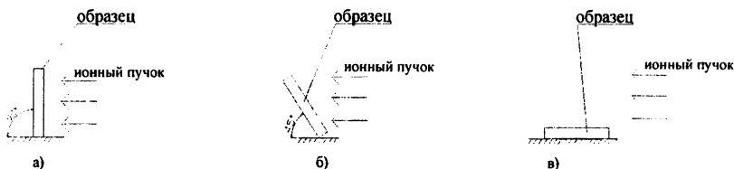
Рис. 2. Схемы воздействия ионного потока на поверхность образца а) ионный пучок под 90^\circ , б) ионный пучок под 45^\circ , в) ионный пучок под 0^\circ
