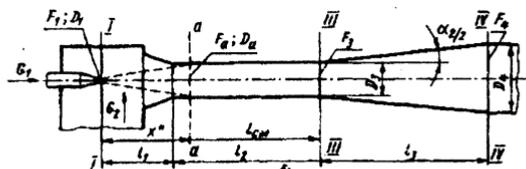
Рисунок 1 – Схема эжектора при скорости эжектируемого газа  $\omega_2 = 0$
