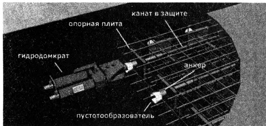
Рисунок 4. Преднапряжение арматуры
