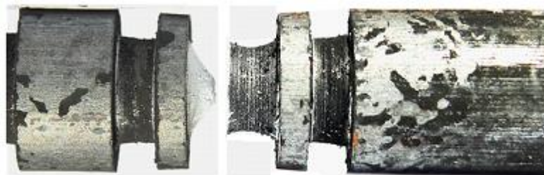
Рис. 7. Вид излома образца типа «gr» и деформированных зон, примыкающих к излому
