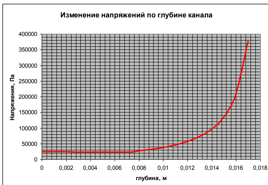
Рис. 3. Расчет изменения напряжений на стенки канала при введении волновода на глубину от 0 мм до 18 мм без пломбировочного материала
