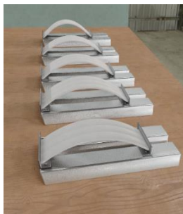
Рис. 1. Общий вид исследуемых образцов. Деформирование принято 20, 30, и 60 % от разрушающей величины
