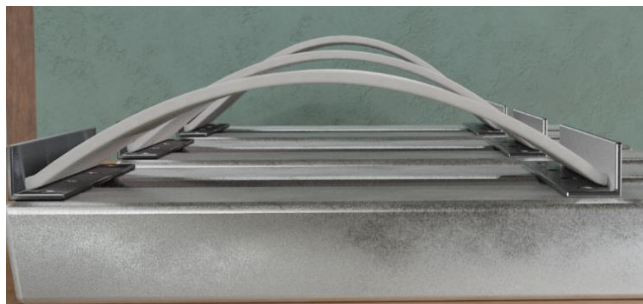
Рис. 1. Общий вид исследуемых образцов. Деформирование принято 20, 30, и 60 % от разрушающей величины
