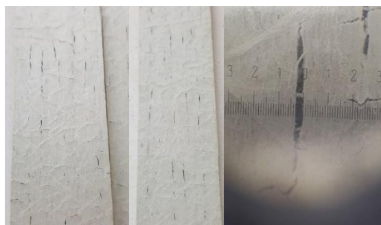
Рис. 2. Разрушение полимерной матрицы по направлению армирования в виде трещин шириной до 0,3 мм, щелочной состав, 600 дней
