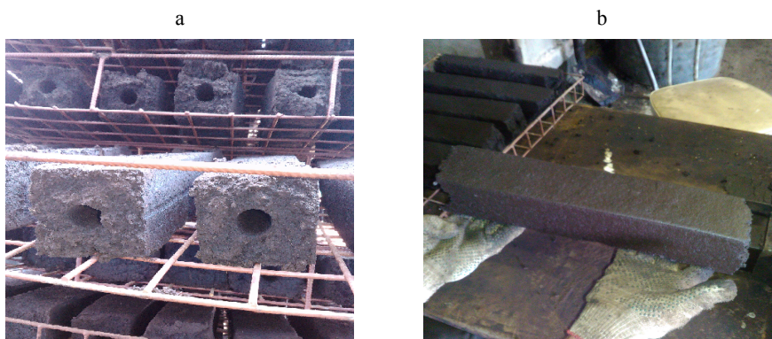
Рис. 5. Внешний вид многокомпонентного твердого топлива: а – сушка брикета в контейнере; б – брикет, получаемый на производстве
