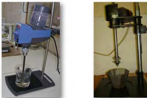
Рис. 6 – Мешалки для приготовления раствора полимера
