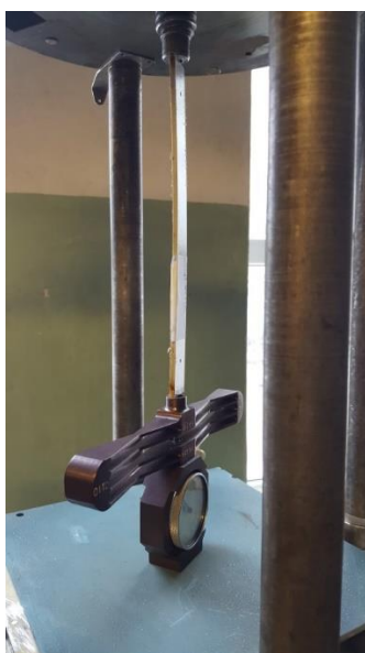
Рис. 3. Проведение разрушающих испытаний образцов
