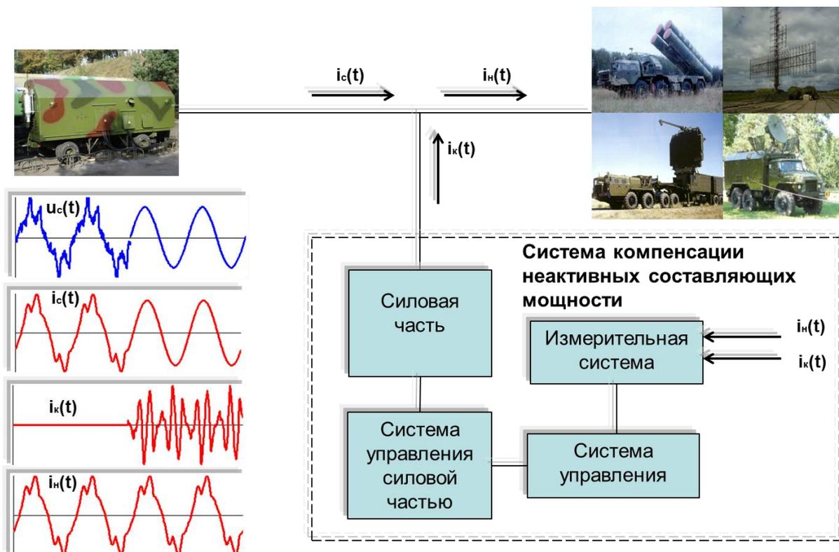
Рис. 4 – Структура системы компенсации неактивных составляющих мощности
