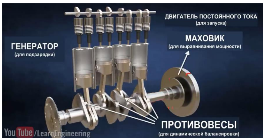
Рис. 2 Принцип работы ДВС
