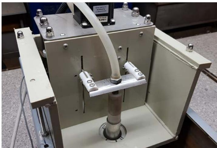
Рисунок 1 – Внешний вид оборудования для получения МДО покрытий на внутренних поверхностях трубчатых изделий
