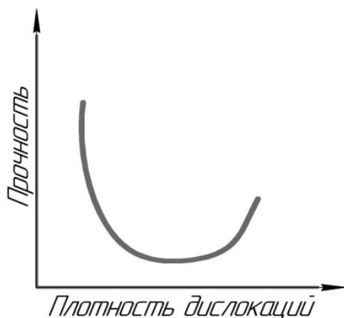
Рисунок 1 – Зависимость прочности материала от плотности дислокаций [3]
