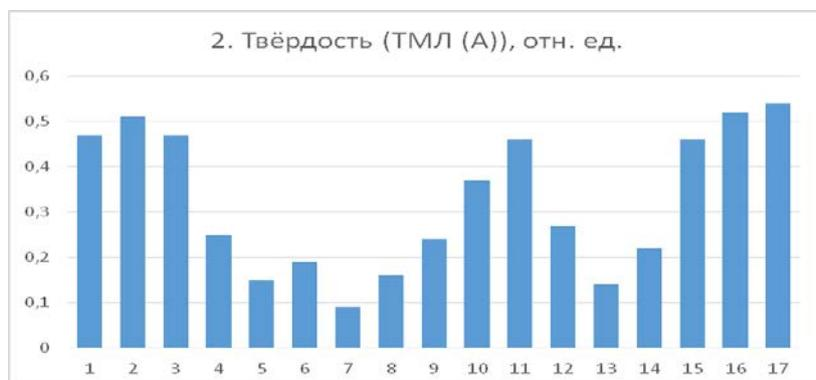
Рисунок 1 – Результаты испытаний покрытий на твердость
