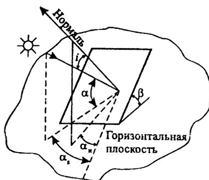
Рис. 1. Углы, характеризующие положение точки на наклонной поверхности относительно солнечных лучей
