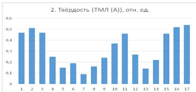
Рисунок 1 – Результаты испытаний покрытий на твердость
