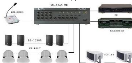
Рис. 1. Схема системы фонового озвучивания
