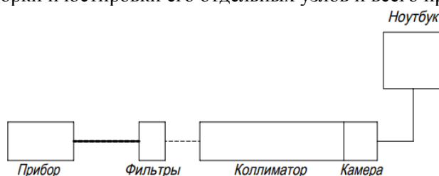
Рис. 1. Схема юстировка расходимости каналов излучателя и приемника
