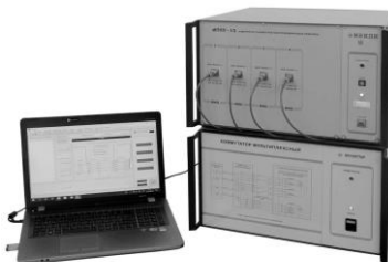
Рис. 1. АИК на основе мультиплексного коммутатора
