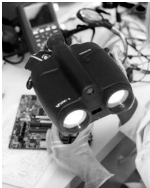
Рис. 1. Внешний вид дальномера ДЛК-1
