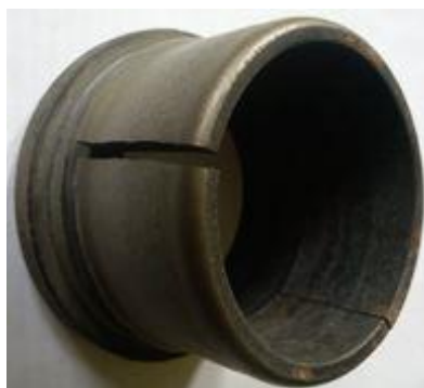
Рисунок 1 – Трещины в покрытии при газотермическом напылении (а), при селективном лазерном плавлении (б).
