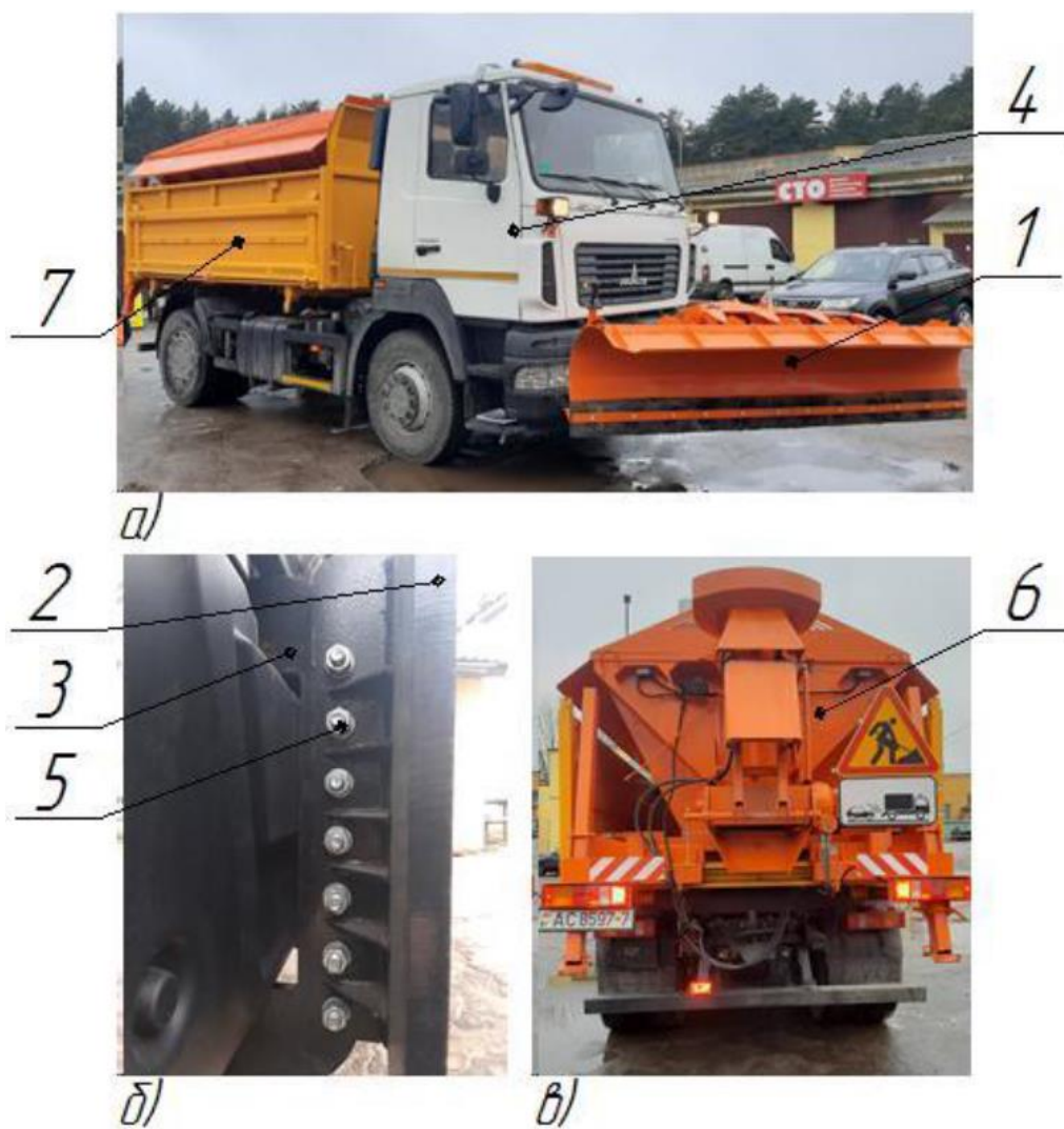
Рисунок 1 – Многофункциональная машина на базе автомобиля МАЗ-5550С5:
