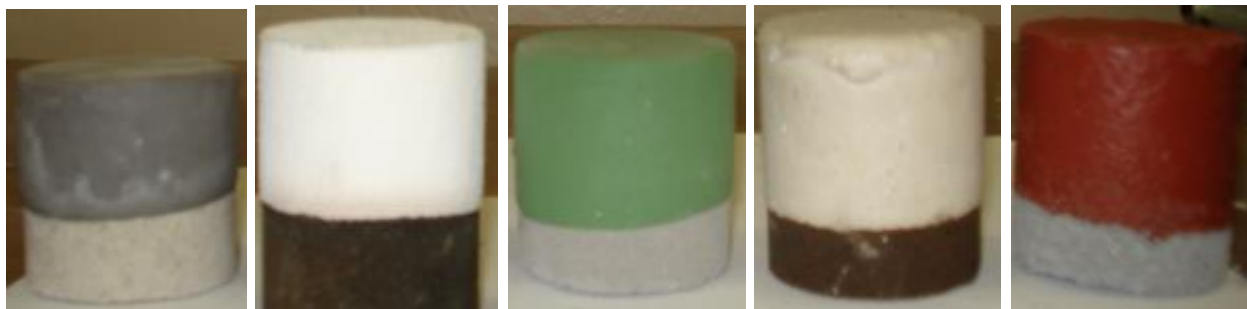
Рисунок 1 – Номенклатура разработанных противопригарных покрытий (покрытия нанесены на поверхность стандартных образцов (50 × 50мм) из формовочных смесей).
