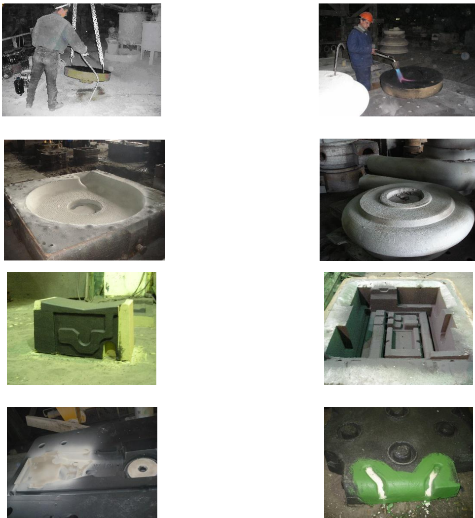
Рисунок 2 – Примеры использования покрытий литейных форм на производстве при изготовлении отливок
