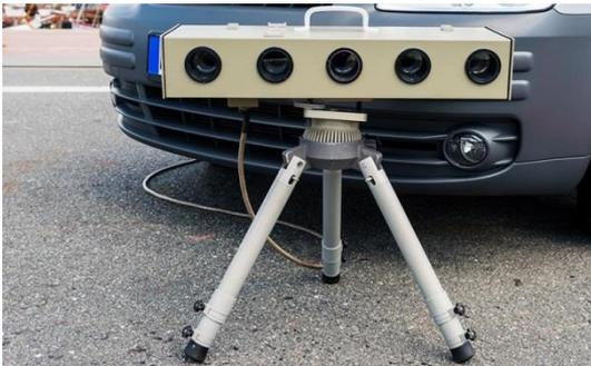
**B.** Es gibt noch eine andere Messmethode, bei der Laserstrahlen zum Einsatz kommen: nämlich bei der sogenannten Einseitensensormessung. Hierbei steht das Gerät im rechten Winkel zur Fahrbahn und sendet mehrere parallel verlaufende Laserstrahlen aus. Fährt nun ein Fahrzeug auf der Straße, durchfährt es nacheinander diese
