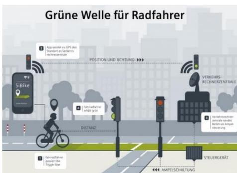
Die von der Firma Siemens Mobility entwickelte kostenfreie App erfasst Geschwindigkeit und Fahrtrichtung des Radlers. Wenn das Fahrrad virtuelle Auslösepunkte an der Strecke passiert, meldet die App die Aktivierung an die Verkehrszentrale. Diese gibt wiederum einen Befehl an die Ampelsteuerung. So löst die App an den Ampeln die Grünphase für Radler bei Bedarf
