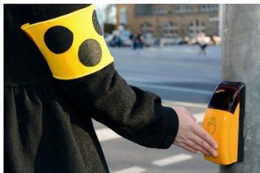
Als "Blindenampeln" bezeichnet man die bekannten gelben Kästen, die in greifbarer Höhe an den Ampelmasten angebracht sind. Ein allgemeiner Irrtum besteht darin, dass viele davon ausgehen, dass eine Ampel mit Knopfdruck schneller auf grün umschaltet. Stattdessen sind diese Schalter nur für blinde oder sehbehinderte Menschen relevant.
