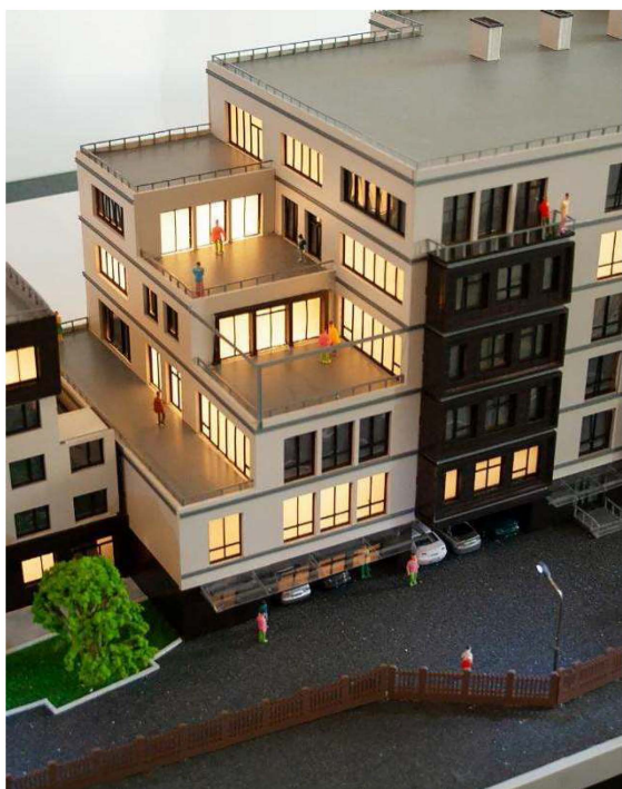
Рис. 4. Фрагмент макета жилой застройки. При изготовлении поверхности стен использовалась плоттерная резка листового ПВХ-пластика. Наблюдается высокая детализация формы
