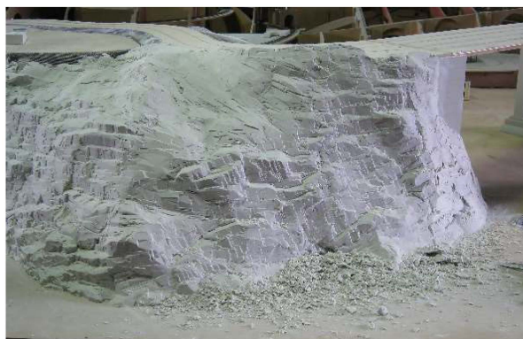
Рис. 1. Петербург. Макет «Гранд Макет Россия». Основа для поверхности рельефа, созданная из гипса
